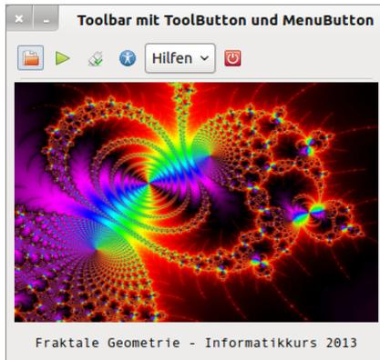
Abbildung 12.3.2.5.1: ToolBar mit ToolButton und MenuButton
